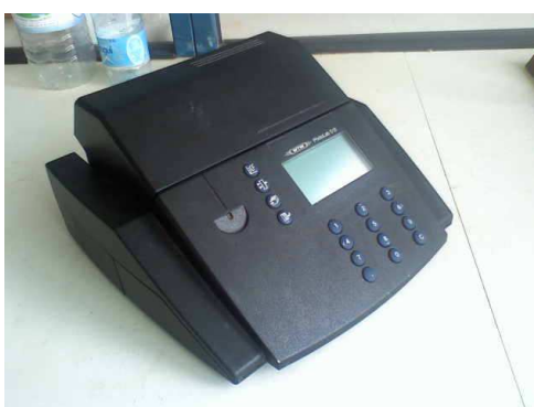
Photo 6: Photomètre WTW PhotoLab S12 pour la lecture des valeurs de DCO
