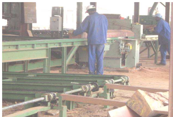
Photo 19 : Eboutage : l'un des postes du circuit matière.
