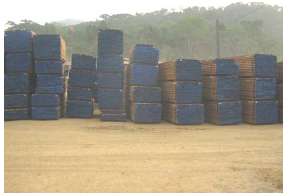
Photo 21 : Peinture bleue aux extrémités des débités
