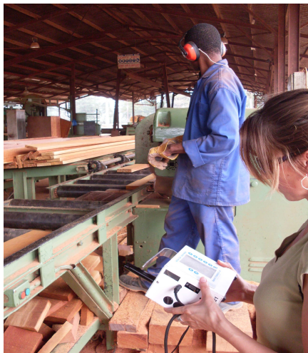
Photo 13 : Mesure de la pollution par les poussières à la scierie
