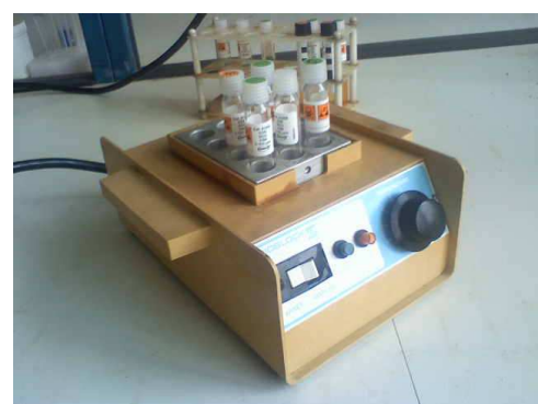
Photo 5: Minéralisateur Bioblock Scientific, pour préparation des échantillons à la mesure de la DCO
